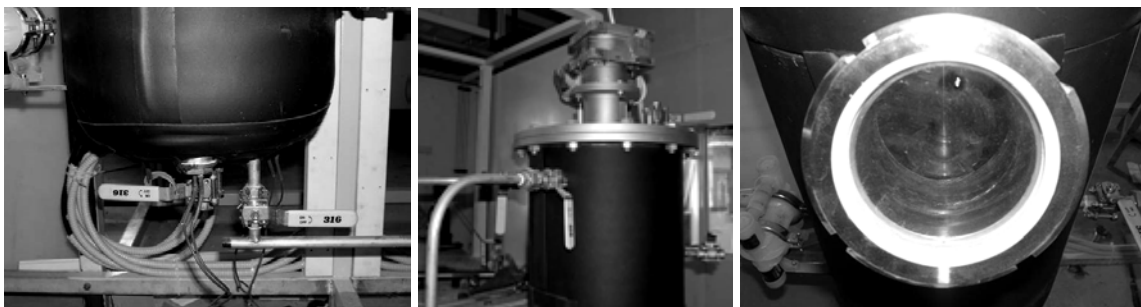
Εικόνα 1. Στοιχεία αντιδραστήρα μετεστεροποίησης RT1 πιλοτικής μονάδας. α) Αντιστάσεις θέρμανσης και βάνες δειγματοληψίας, β) άνω τμήμα αντιδραστήρα - κινητήρας γ) θυρίδα οπτικού ελέγχου
